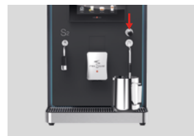
Dampfhahn schliessen, sobald der gewünschte Schaum oder die gewünschte Temperatur erreicht ist. Danach Gefäss sofort entfernen.
