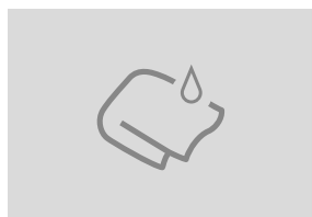
Dampflanze mit feuchtem Lappen reinigen. Achtung: Verbrennungsgefahr!
