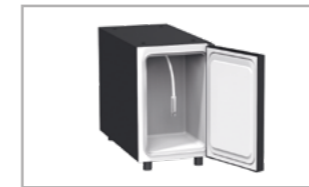
Reinig met de microvezeldoek de koelinstallatie, de melkaanzuiging en -leidingen. Besproei vervolgens met de desinfecterende spray en laat drogen.
